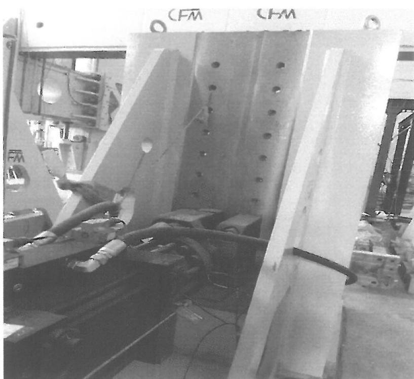
Рисунок 2.3 Расположение гидроцилиндров относительно стальных упоров
