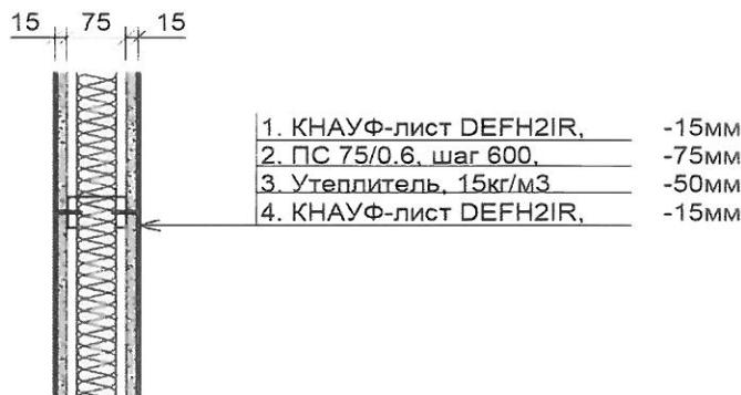
Рисунок 3.5 Состав перегородки.
