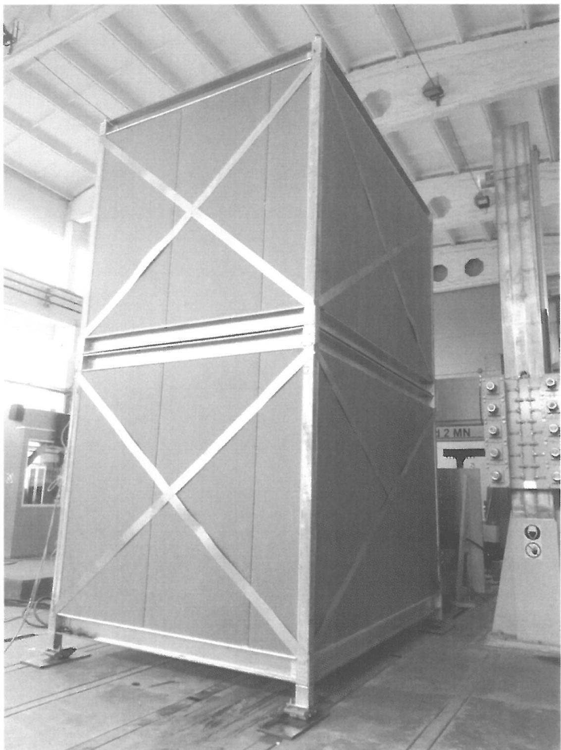
Рисунок 1.11 Общий вид 2-х этажного экспериментального фрагмента модуля,
