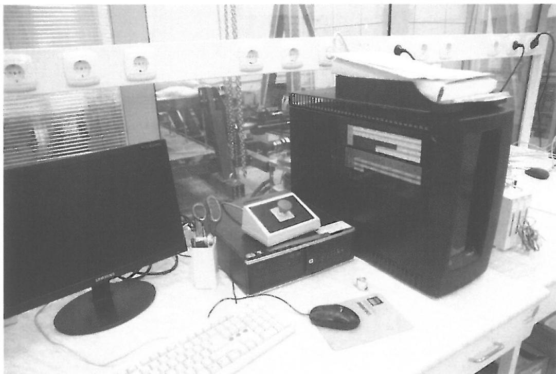
Рисунок 2.7 Цифровой контроллер MTS FlexTest 60 Digital Controller
