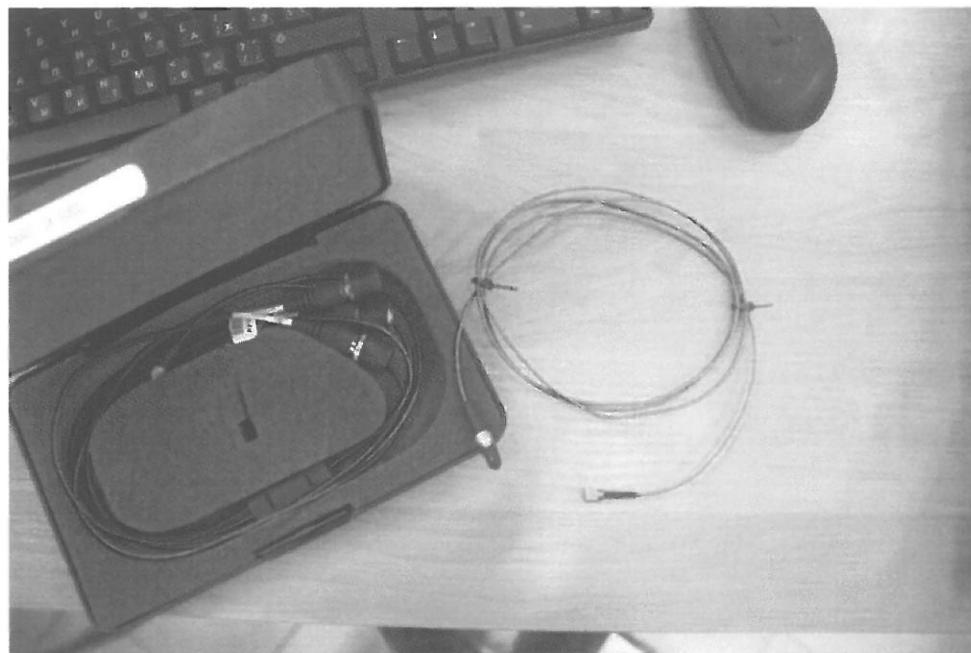
Рисунок 2.5 Акселерометры трехосные, фирмы PCB
