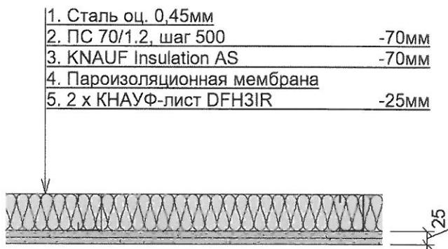
Рисунок 3.4 Состав панели потолка.
