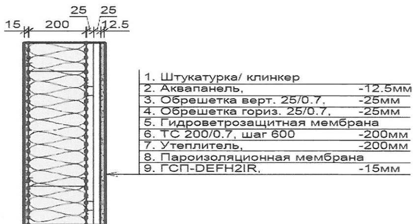
Рисунок 3.6 Состав панели наружной стены.
