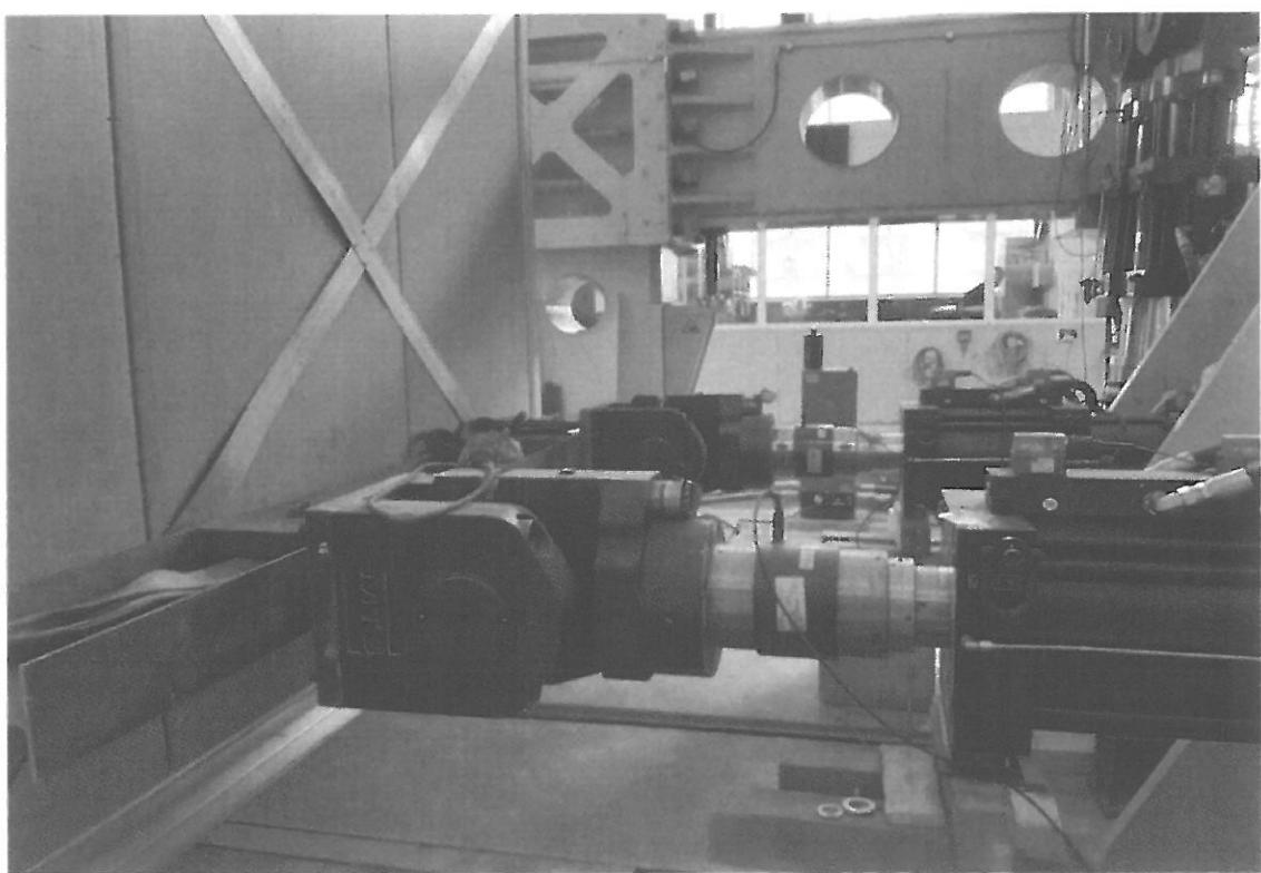
Рисунок 2.2 Расположение гидроцилиндров относительно 2-х этажного фрагмента
