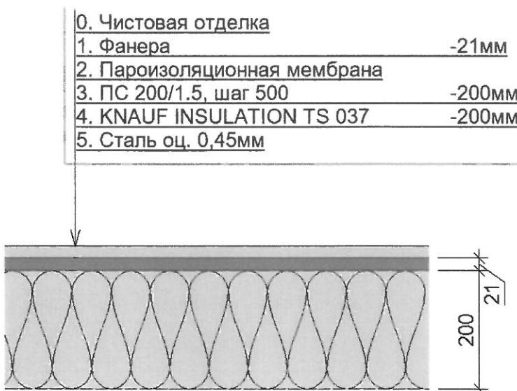
Рисунок 3.3 Состав панели пола.
